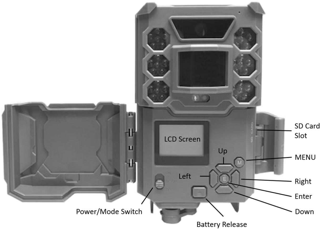
**INSTALLING THE BATTERIES AND SD CARD**
