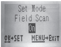
(Schritt 1)- Field Scan-Modus auf „On“ (Ein) festlegen
