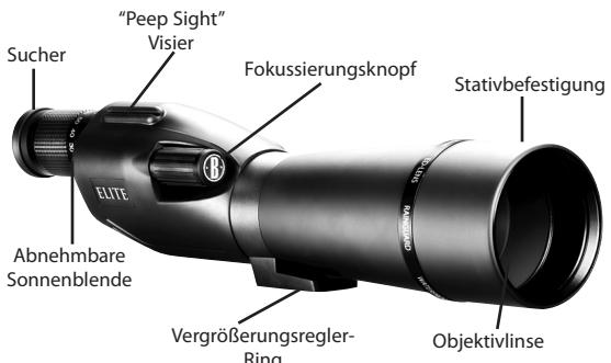
Diese Abbildung dient zur Bezeichnung der im Text erwähnten Bedienungselemente Ihres ELITE®-Perspektivs.
